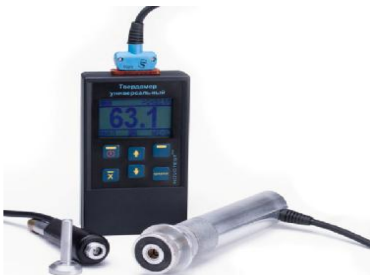
Рисунок 1 – Внешний вид блока обработки информации и преобразователей
